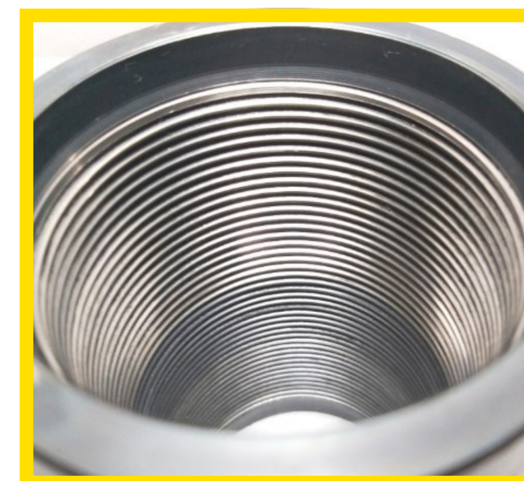
Внешний вид резьбы муфты после испытаний
