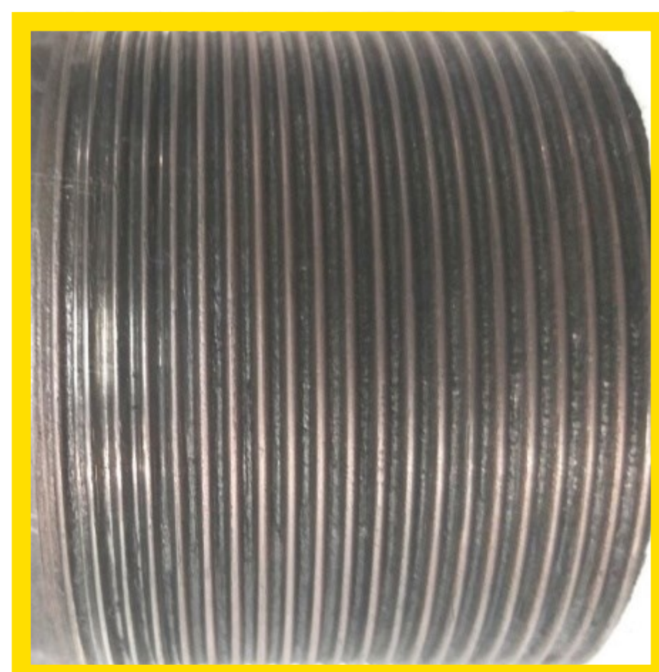
Внешний вид ниппеля после испытаний
