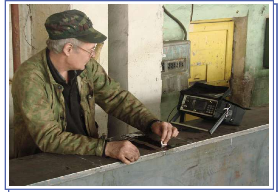
Ультразвуковой контроль качества сварных швов
