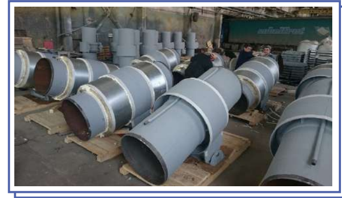
Опора неподвижная с теплоизоляцией ППУ
