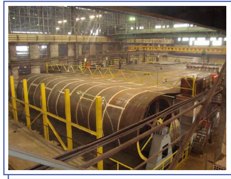
Стан для сварки под флюсом рулонных металлоконструкций для РВС
