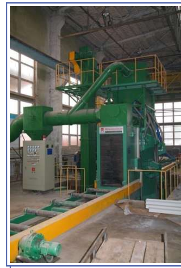
Установка дробеметной очистки
