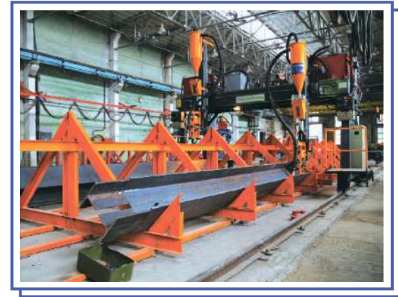
Портал для сварки балки
